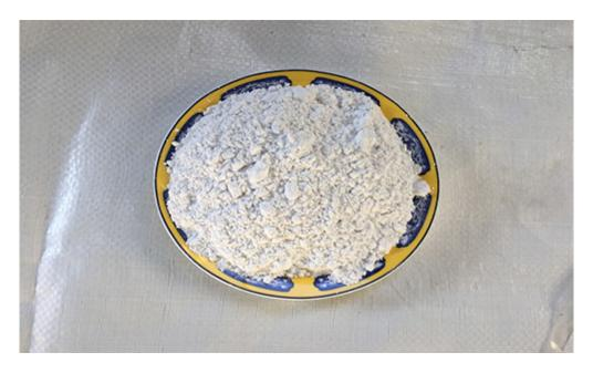
在混凝土模板内表面上涂刷脱模剂的目的在于减少混凝土与模板的粘结力而易于脱离,不致因混凝土初期强度过低而在脱模时受到损坏,保持混凝土表面光洁,同时可保护模板,防止其变形或锈蚀,便于清理和减少修理费用,为此,脱模剂须满足下列要求:1、良好的脱模性能拆模时,要求脱模剂能使模板顺利地与混凝土脱离、保持混凝土表面光滑平整、棱角整齐无损。2、涂敷方便、成模快、拆模后易清洗脱模剂既能涂刷又能喷涂为好、成模要快(一般20分钟之内)拆模后易于,这样才不影响施工进度和制品生产率。3、不影响混凝土表面装饰效果混凝土表面不留浸渍印痕、反黄变色4、不污染钢筋、对混凝土无害不影响混凝土与钢筋的握裹力、不改变混凝土拌合物的凝结时间,不应含有对混凝土性能有害的物质。5、保护模板、延长模板使用寿命木模用脱模剂应能渗入木模表面,对模板起维护和填缝的作用,并能防止模板多次使用后由于木质和边角的变异而产生膨胀、隆起、开裂及其疵病。钢模用脱模剂应具有防止钢模锈蚀及由此导致混凝土表面产生锈斑的作用。6、具有较好的稳定性混凝土脱模剂应有较好的稳定性和较长的贮存期。宇恒陶瓷提供更多面的售后服务。淄博陶瓷骨粉脱模剂优点
